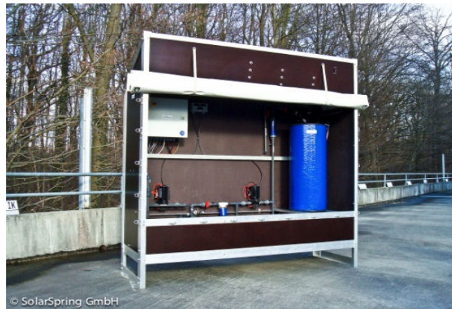
Figure 22 : Vue arrière de l'unité Oryx 150. Le module DM à spirales est la cuve bleue sur la droite.
