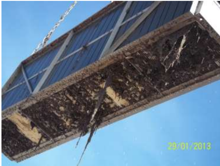
Bouchage des membranes plates et formation de boue
